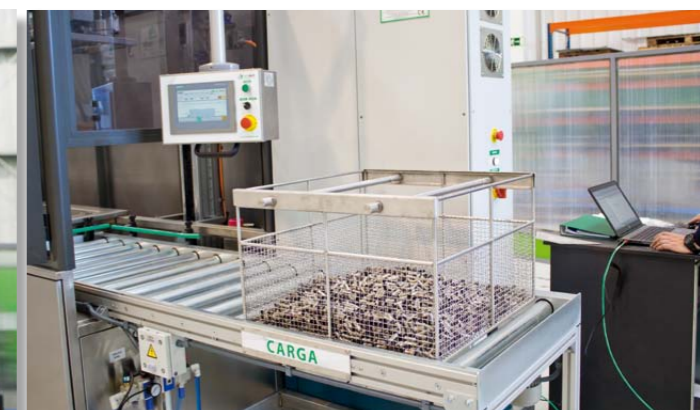
Вход корзины с деталями в ультразвуковую станцию. Стойки и корзины изготавливаются по заказу клиента.
