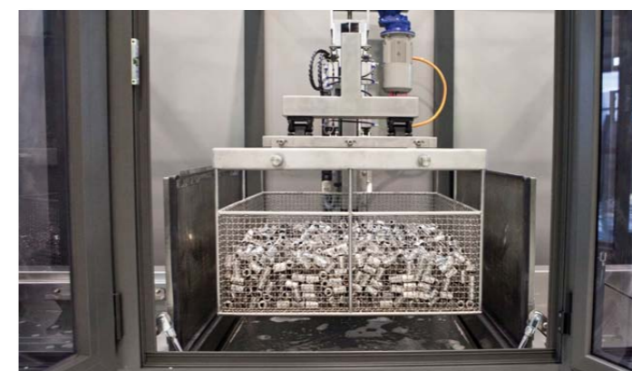
Горячая промывка корзины с деталями в резервуаре. Компьютер обеспечивает многоступенчатую сушку и пассивацию деталей.
