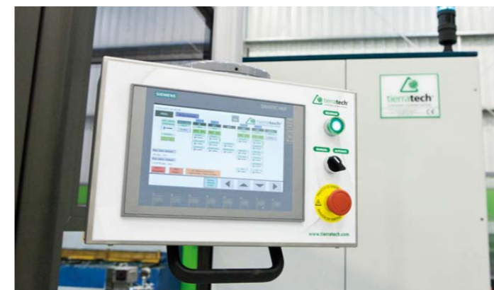
Панорамная 9-ти дюймовая панель СИМЕНС мод. КТР900 TFT. Подсветка 800 x 480 пикселей. Такие панели установлены на всем автоматическом оборудовании данной серии.
