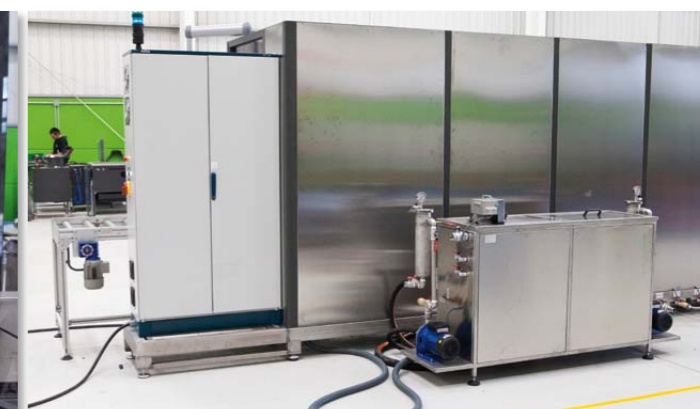
Слив масла из резервуара с фильтрацией
